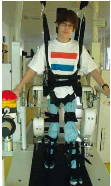
Lauftraining am Lokomat
